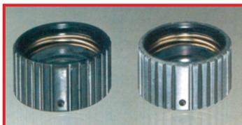
Los depósitos de sales son solubles en ácido con lo que se pueden quitar con un producto de limpieza general ácido. Recomendamos prestar una atención especial a los datos e indicaciones del fabricante del detergente en lo que se refiere a la compatibilidad de materiales.
