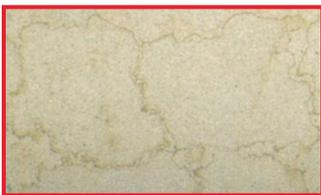
Ejemplo de manchas debidas a impureza en el vapor de condensación
