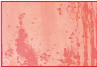
Alteración óptica de aluminio metalizado ya en presencia de alcalinidad media
