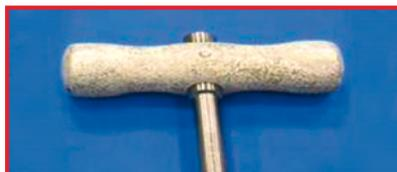
Ataque al material del revestimiento de aluminio del mango Origen: Producto de limpieza alcalino inapropiado
