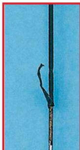
Aislamiento dañado en un instrumento de alta frecuencia
