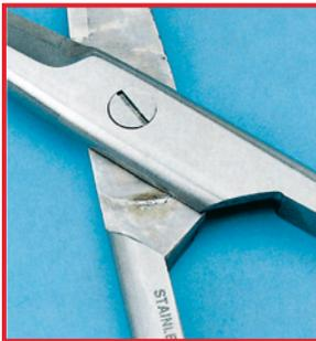
Corrosión debida a la fricción por no haber aplicado lubricante
