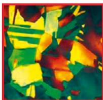
Grabado de color - microestructura austenítica de acero anticorrosivo y resistente al ácido para instrumentos (resolución x500)
