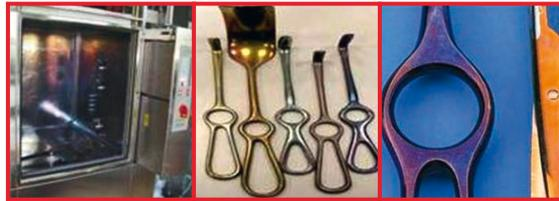
Típicas descoloraciones de silicatos en la cámara de aclarado y en la superficie de los instrumentos por productos de limpieza que contengan silicatos o un elevado contenido de ácido silícico en el agua
