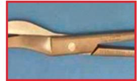
Ataque decapante de la superficie del instrumento. Causa: Ataque del ácido por sobredosis.
