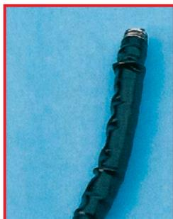
Hinchamiento en el extremo distal de un fibroendoscopio
