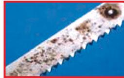
Ataque al material de la capa de cromo parcialmente defectuosa. Causa: La humedad produce una formación de óxido del material base desnudo de acero normal
