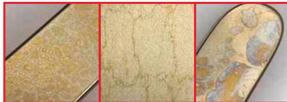
Típicas descoloraciones de silicatos en la superficie de los instrumentos tras la esterilización por vapor debido al elevado contenido de ácido silícico en el agua completamente desalinizada.
