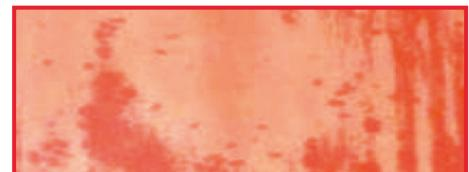
Ataque al material de la superficie de aluminio anodizado natural/metalizado en contenedores. Causa: solución de lavado con nivel de alcalinidad no permitido
