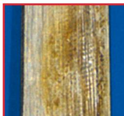
Punzón de huesos, la superficie de deslizamiento de la pieza corredera muestra corrosión por fricción
