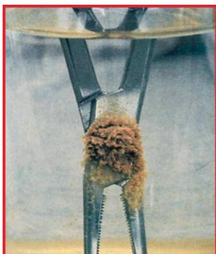
Formación de óxido por inmersión durante varias horas en una solución de cloruro de sodio
