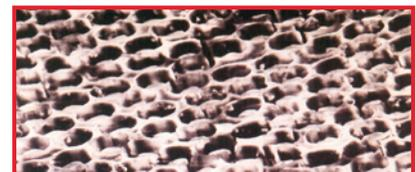
Detalle – Ataque al material de un conductor de fibra óptica Origen: Ataque alcalino por no respetar las indicaciones del fabricante de emplear un detergente neutral.
